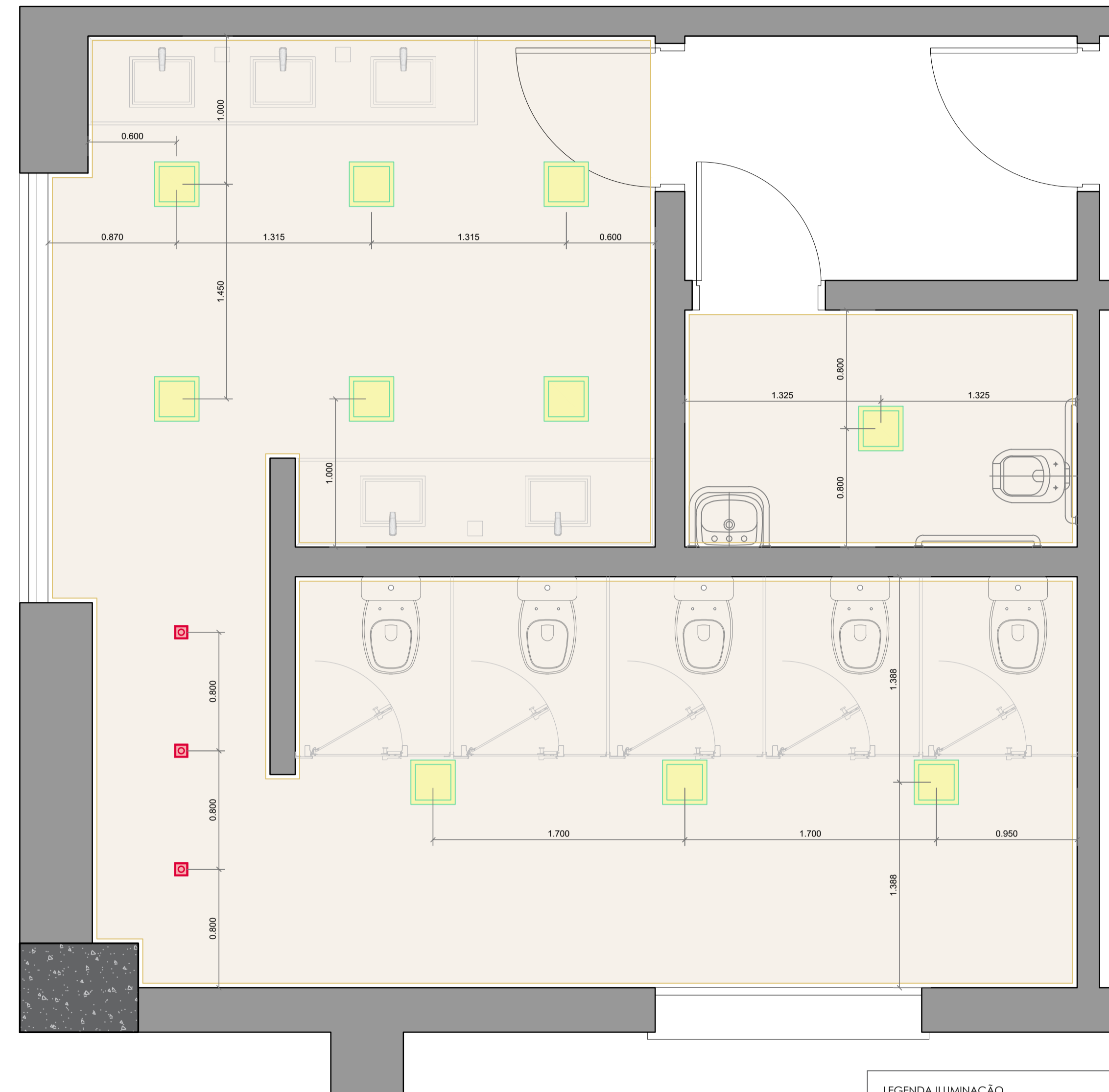
PLANTA - FORRO E ILUMINAÇÃO escala: 1:25
