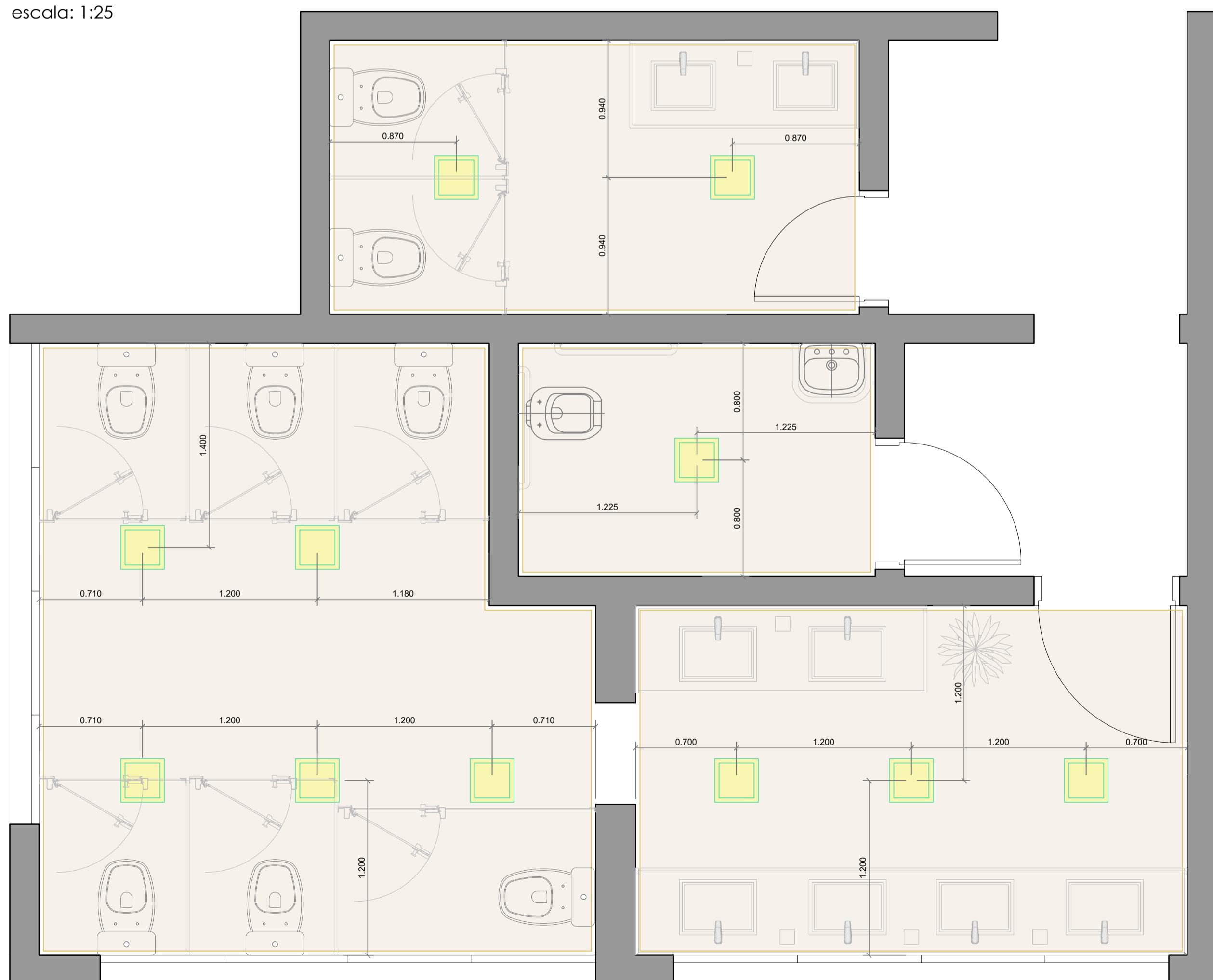
PLANTA - FORRO E ILUMINAÇÃO escala: 1:25
