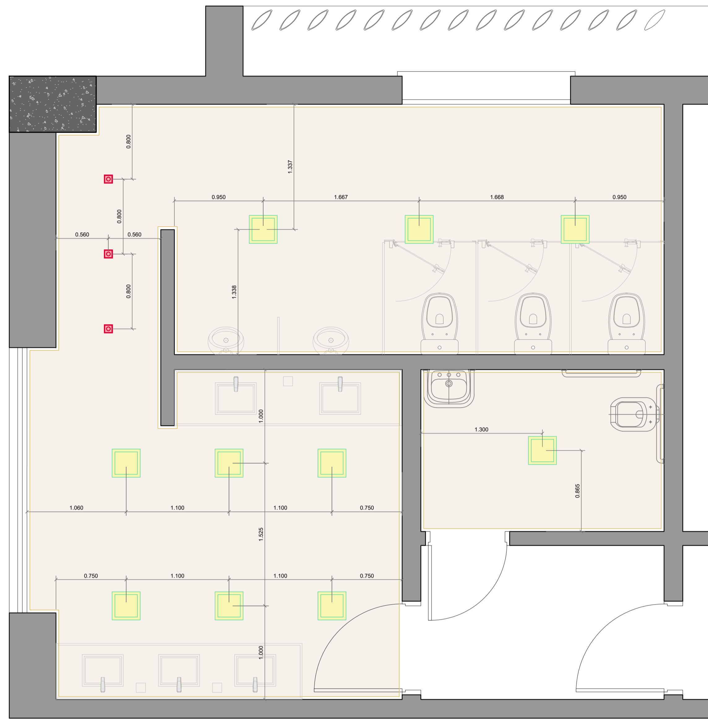
PLANTA - FORRO E ILUMINAÇÃO escala: 1:25
